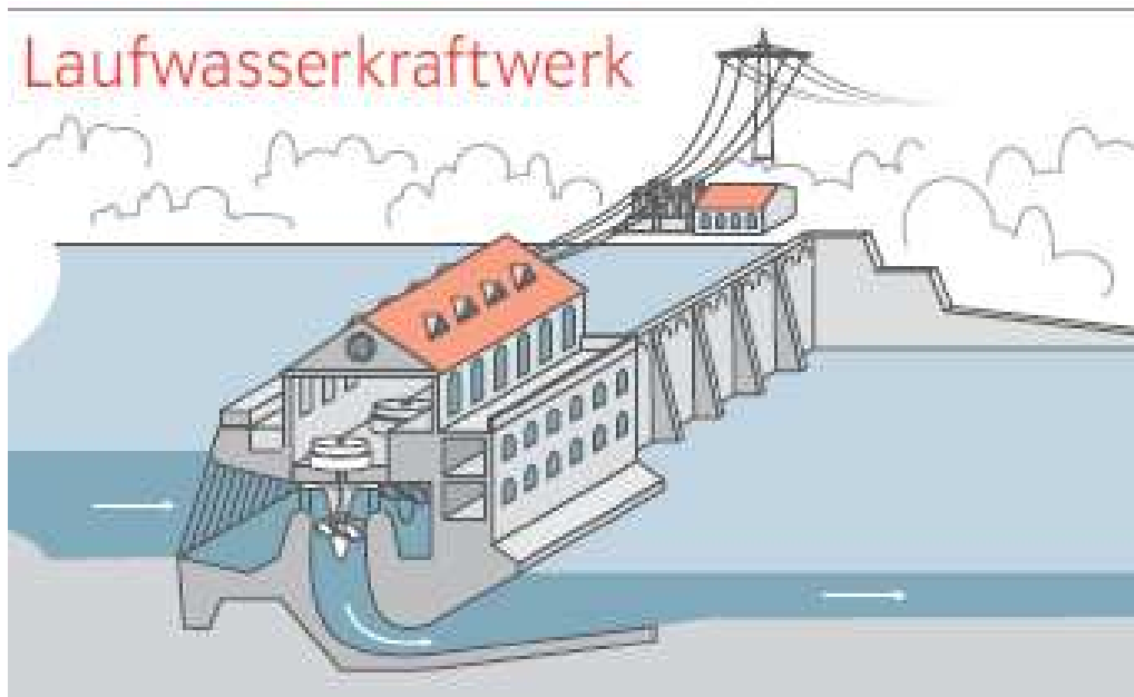
Abbildung 7: Prinzip eines Laufwasserkraftwerks
